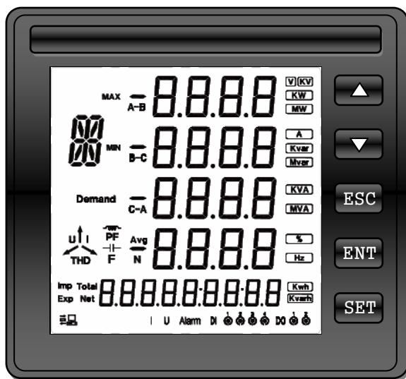
仪表的前面板右方有五个操作按键，从下至上分别标记为  $\triangle$  键， $\nabla$  键，ESC键、ENT键和SET键。通过五个按键的操作可以实现不同量测数据的显示以及参数的设定。
