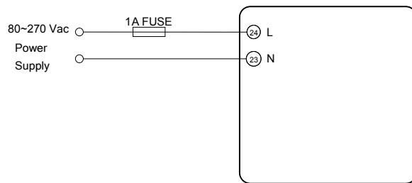
仪表供电的电源回路中必须加装保险丝或小型空气断路器, 保险丝可选用 1A/250Vac, 长延时型保险丝, 如使用小型空气断路器, 建议使用符合 IEC947 标准并通过 CE 认证的产品。
